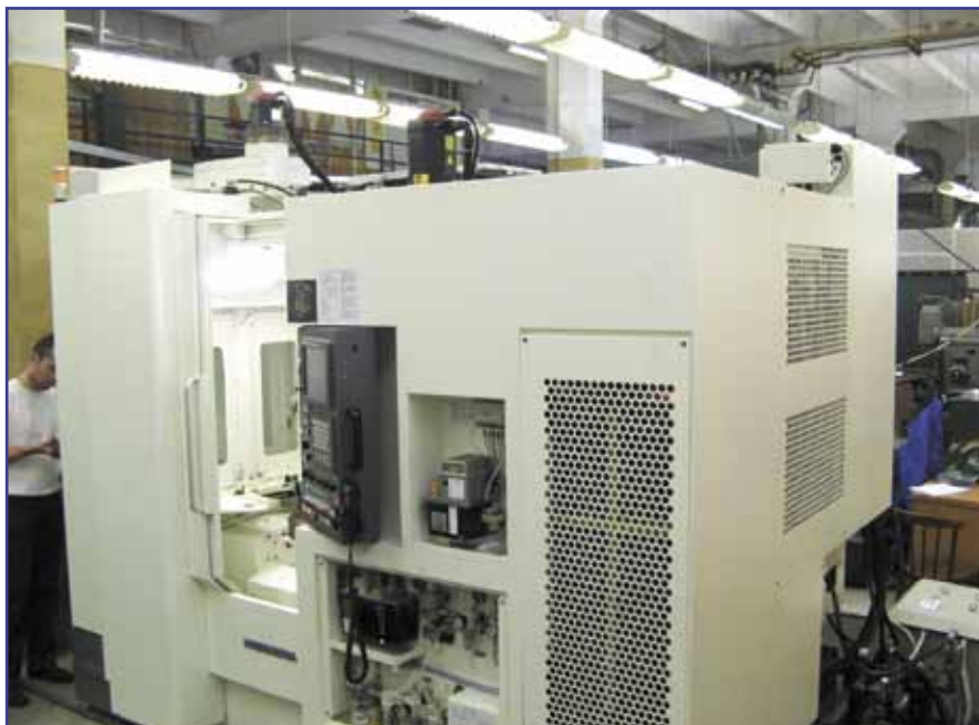
Рис. 1. Обрабатывающий центр KITAMURA в механосборочном цехе предприятия.
