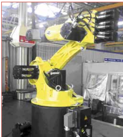
Рис. 7. Технологический робот TUR 15 с ЭД серии ДБМ.
